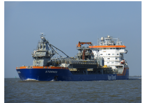
Van Oord's flexible fallpipe vessel, Stornes.
